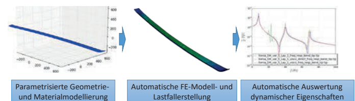
Abb. 2: Optimierungsschema der Schwingungseigenschaf- ten eines Skis.
