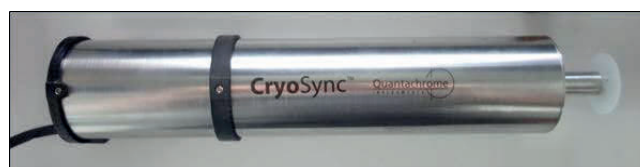
Abb. 1: Regelbarer Kryostat CryoCync im Temperaturbereich -196\text{ °C} bis -153\text{ °C}
