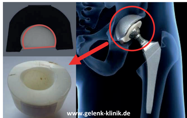
Abb. 1: Verschlissenes Inlay einer Hüfttotalendoprothese
