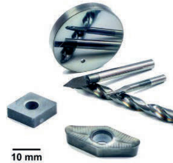
Abb. 1: Verschiedene Materialien mit superharten spannungsfreien ta-C-Schichten unterschiedlicher Dicke
