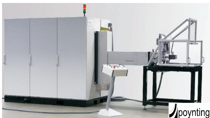
Die neue multifunktionale Stoßstromanlage zur Impulsbearbeitung der Firma Poynting GmbH Dortmund
