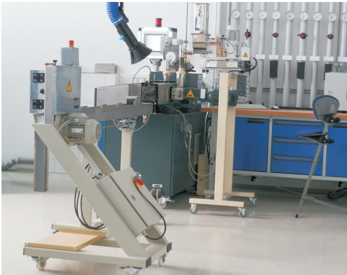
Extruder Coperion ZSK 18 MEGALab im IfP-Neubau
