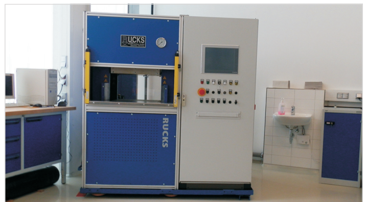
Thermopresse KV249.01 Rucks Maschinenbau GmbH im IfP-Neubau
