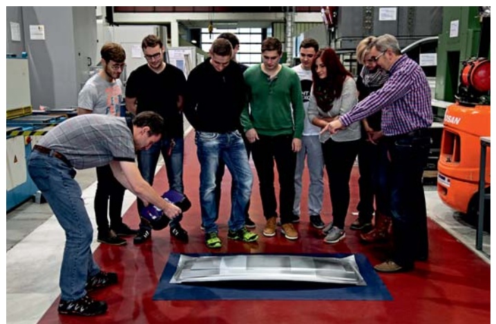
Prof. Kolbe (re.) und Dipl.-Ing. Wienold mit einer Praktikumsgruppe während der Formänderungsanalyse an einem Karosserieblechteil mit dem neuesten optischen System „AutoGrid® comsmart“. Weitere Hinweise unter: vialux.de
