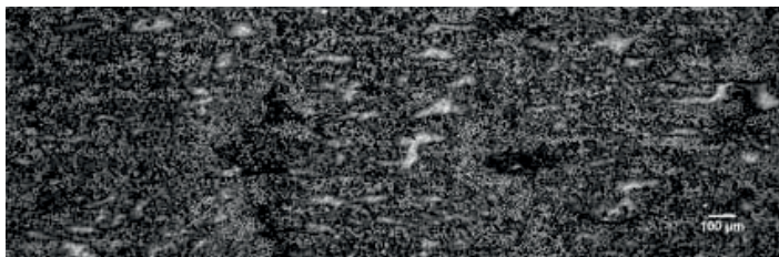
Bild 5: LM-Bild des Querschliffs eines gedruckten Faserverbundes EP-GF (0°)
