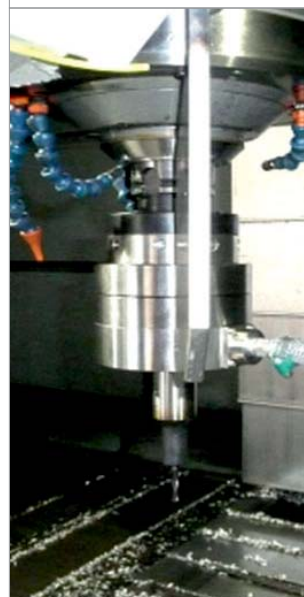
Bild 2: Ultraschallbohrereinheit in einem Bearbeitungszentrum (li.) und Kraftreduktion bei der Stahlzerspanung (o.)
