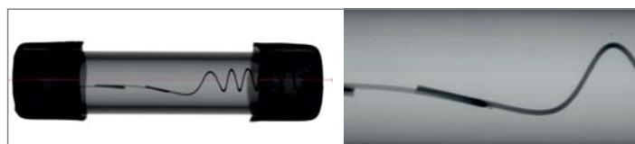
Röntgendurchstrahlungsaufnahmen einer Feinsicherung bei unterschiedlichen Vergrößerungen
