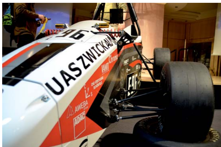
Leichtbauweise am markantesten Bauteil, dem Vollcarbonmonocoque
