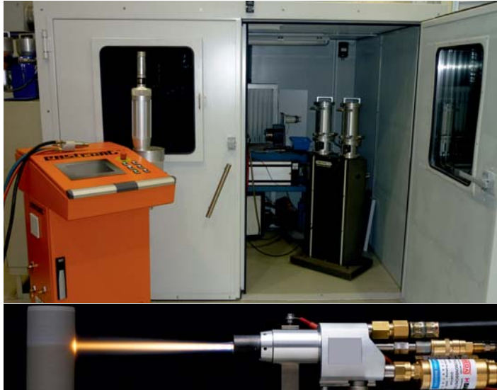
HVOF-Spritzanlage zur Verarbeitung von pulver- und drahtförmigen Zusatzwerkstoffen (oben) und Spritzbrenner (unten)
