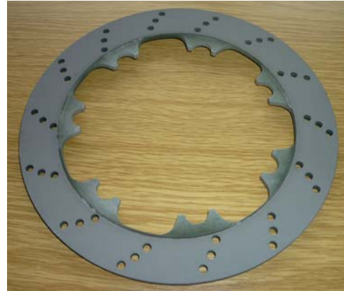
Mit Hartmetall beschichtete Leichtmetall-bremsscheibe für das WHZ Racing Team
