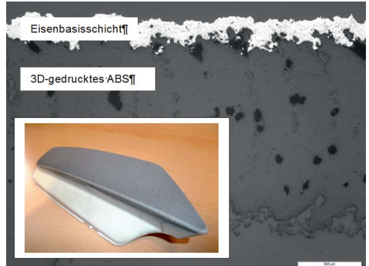
Querschliffaufnahme und Foto eines beschichteten 3D-Druckteils (PKW-Lampengehäuse) für bspw. Windkanaltests
