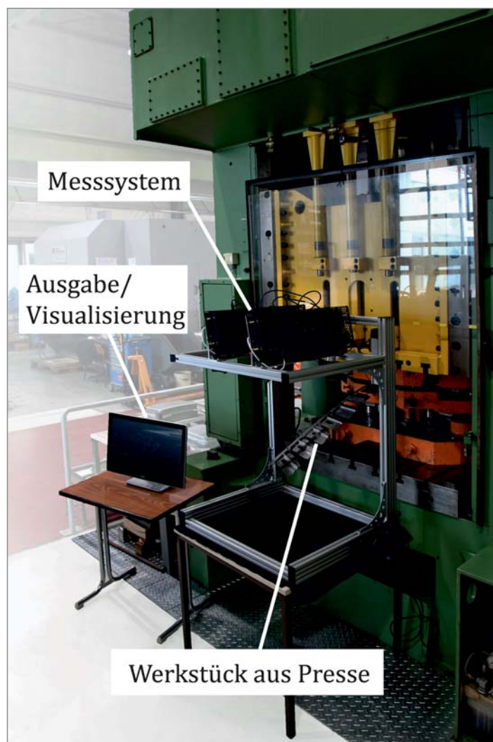
Bild 2: Inline-Messsystem MCS4 an einer Presse bei der Herstellung von Umformteilen
