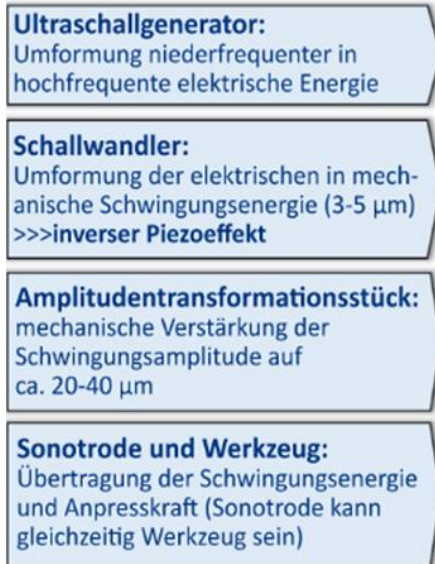
Abb.1: Prinzip des Ultraschallschwingers und des geplanten Entschichtungsprozesses
