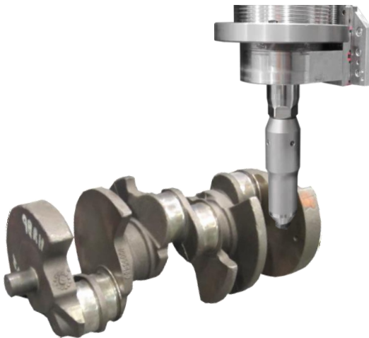
Abb. 1: Ultraschallanlagentechnik zur Nachbehandlung von Kurbelwellen
