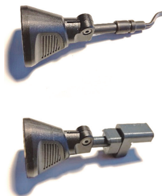
Abbildung 11: Neue Spitzen zum händischen teachen mit dem TracePen (links Entgratklinge, rechts rechtwinklige Ausführung zum teachen gerader Kanten)
