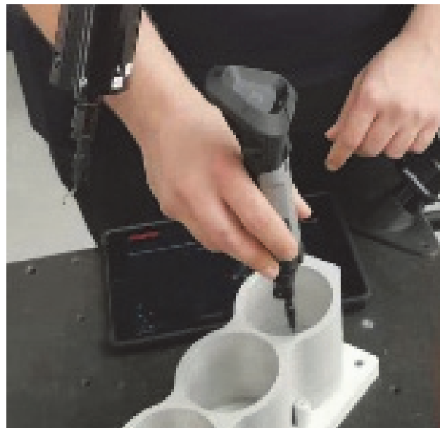
Abbildung 10: Handhabung des TracePen beim Teachen (Teaching by Demonstration)
