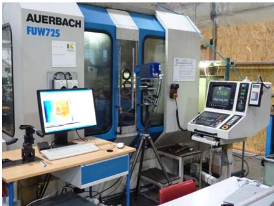
Fräsmaschine mit Schutzfenster und Infrarotmesssystem Jade von FLIR GmbH Frankfurt/Main (ehemals CEDIP) im Versuchsfeld Spannungstechnik der WHZ
