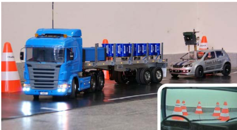
Abb. 2: ART-Truck mit autonomem Verfolgerfahrzeug
