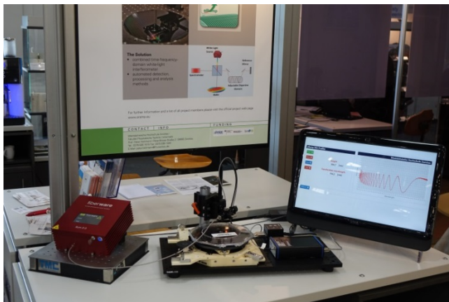
Abbildung 6: Experimenteller Aufbau zum aus-gestellten eRamp-Projekt. Mit einer an der WHZ entwickelten Supercontinuum-Quelle werden Höhenunterschiede auf einem prozessierten Wafer gemessen.
