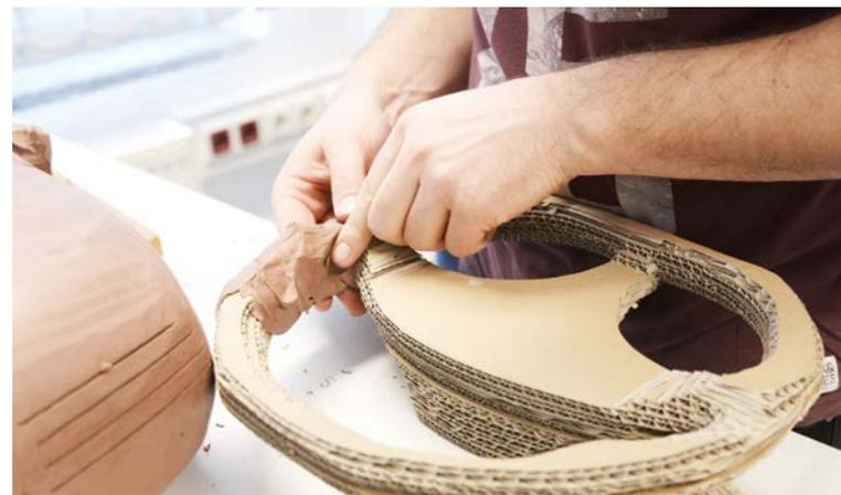
► Vormodell des Lenkrades zur ergonomischen Überprüfung
