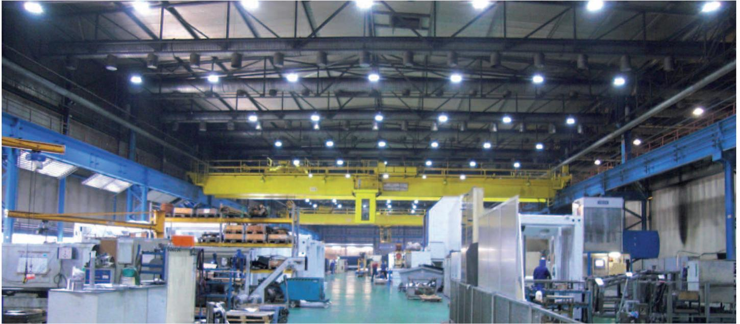
Mit dem Ersatz alter Lampen durch neue LEDs ergab sich bei der Ermafa in Chemnitz eine Ersparnis von rund 20.000 Euro im Jahr.
