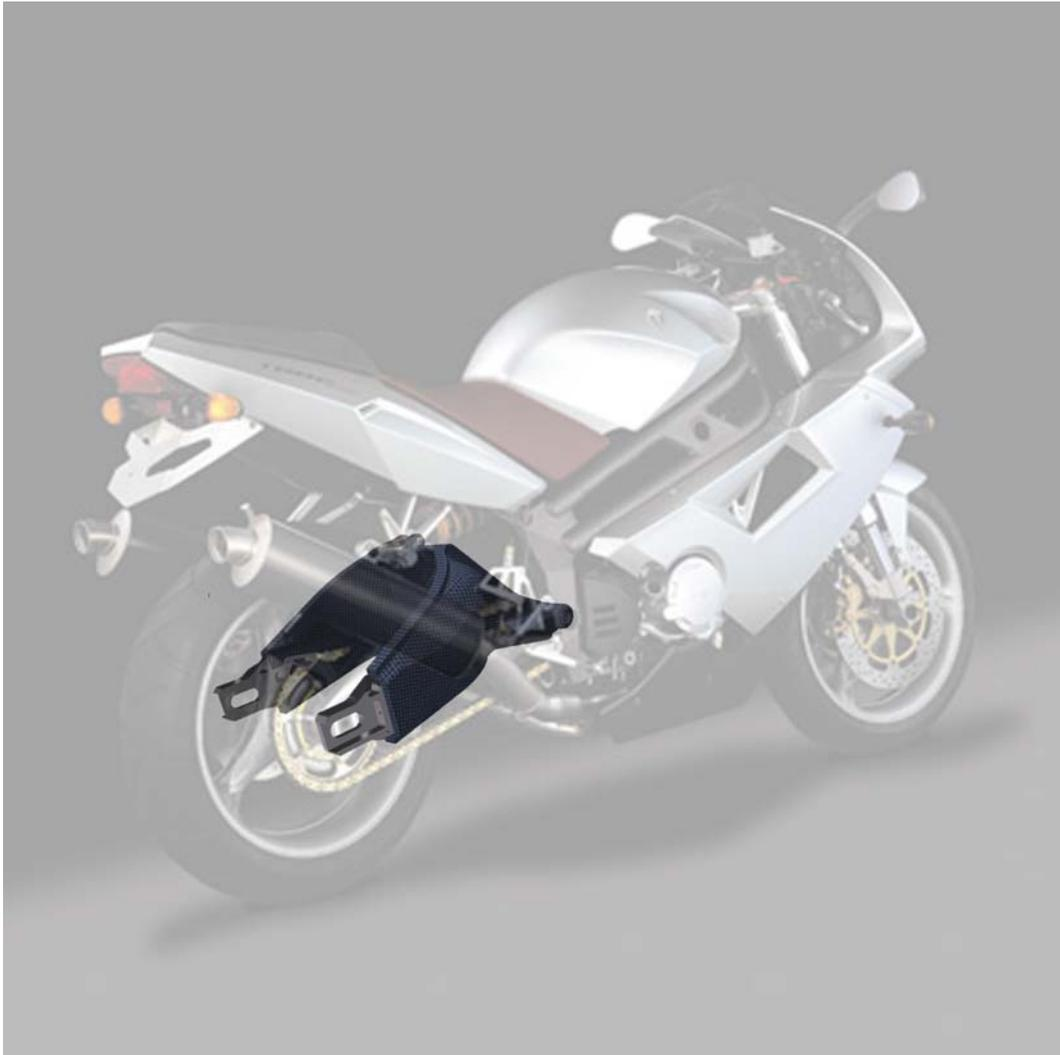
Die Hinterradschwinge aus CFK im Fahrzeug
